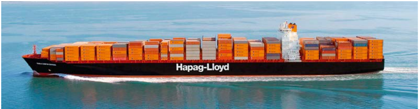
Langstreckenfahrzeug. Der 8.750-TEU-Containerfrachter „Kuala Lumpur Express“ von Hapag-Lloyd wurde 2007 bei Hyundai in Korea gebaut.
